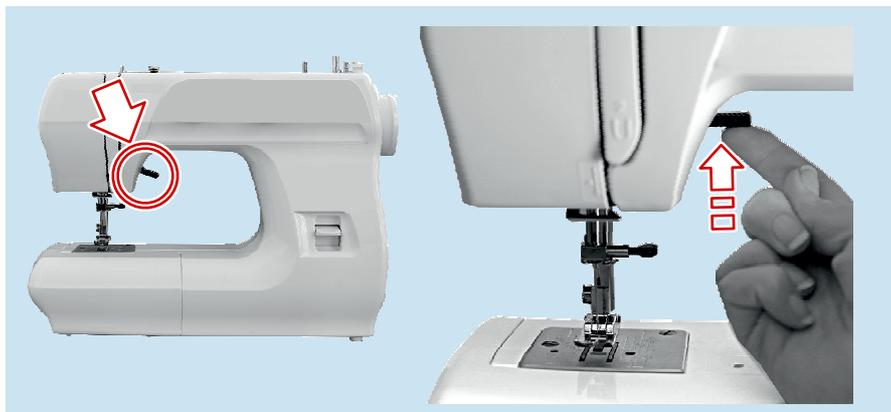
3. Ziehen Sie den **«Anschietisch»** gerade nach links aus der Halterung.
