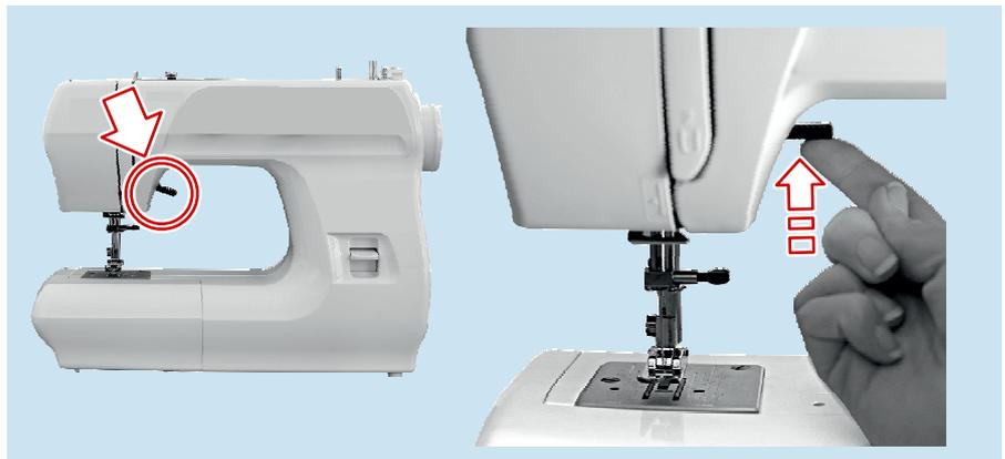
▼ Für einige Nähfüße kann der **«Nähfuß-Hebel»** zusätzlich angehoben werden. In dieser Stellung rastet der Nähfuß-Hebel nicht ein.
