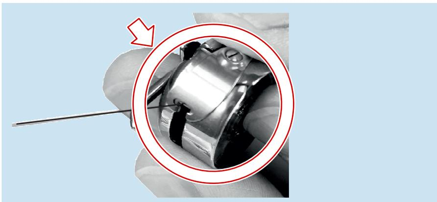
5. Die Spulenkapsel nun mit der Unterfadenspule in die W6-Nähmaschine mit sanftem Druck des Daumens einsetzen.
