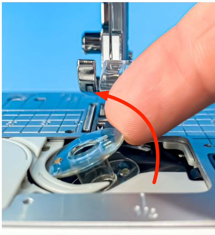
4. Entnehmen Sie die Kunststoffspule aus dem schwarzen Spulenträger, indem Sie mit dem rechten Zeigefinger unter den Rand der Spule greifen und diese herausheben.
