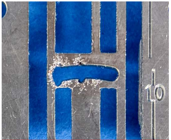
Bild: beschädigte Metallstichplatte!
