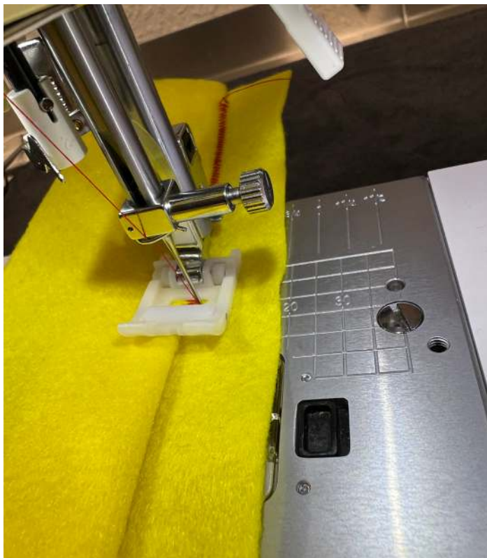
Foto: Unterseite der Naht, beim Nähen mit dem W6 Antihaft Rollenfuß
