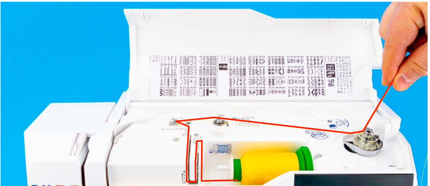
15. Halten Sie das Fadenende, dass Sie durch das Loch in der W6 Kunststoffspule gefädelt haben, fest.
