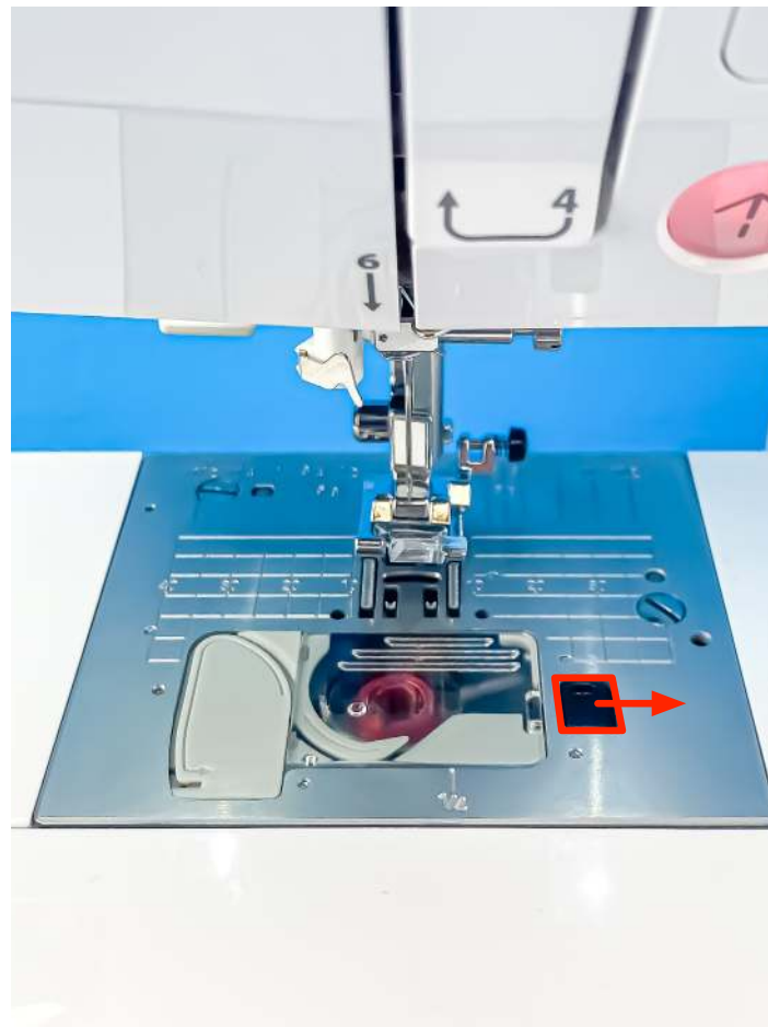
3. Schieben Sie den schwarzen Öffnungsmechanismus zum Öffnen der durchsichtigen Greiferabdeckplatte nach rechts. Entfernen Sie die durchsichtige Greiferabdeckplatte.
