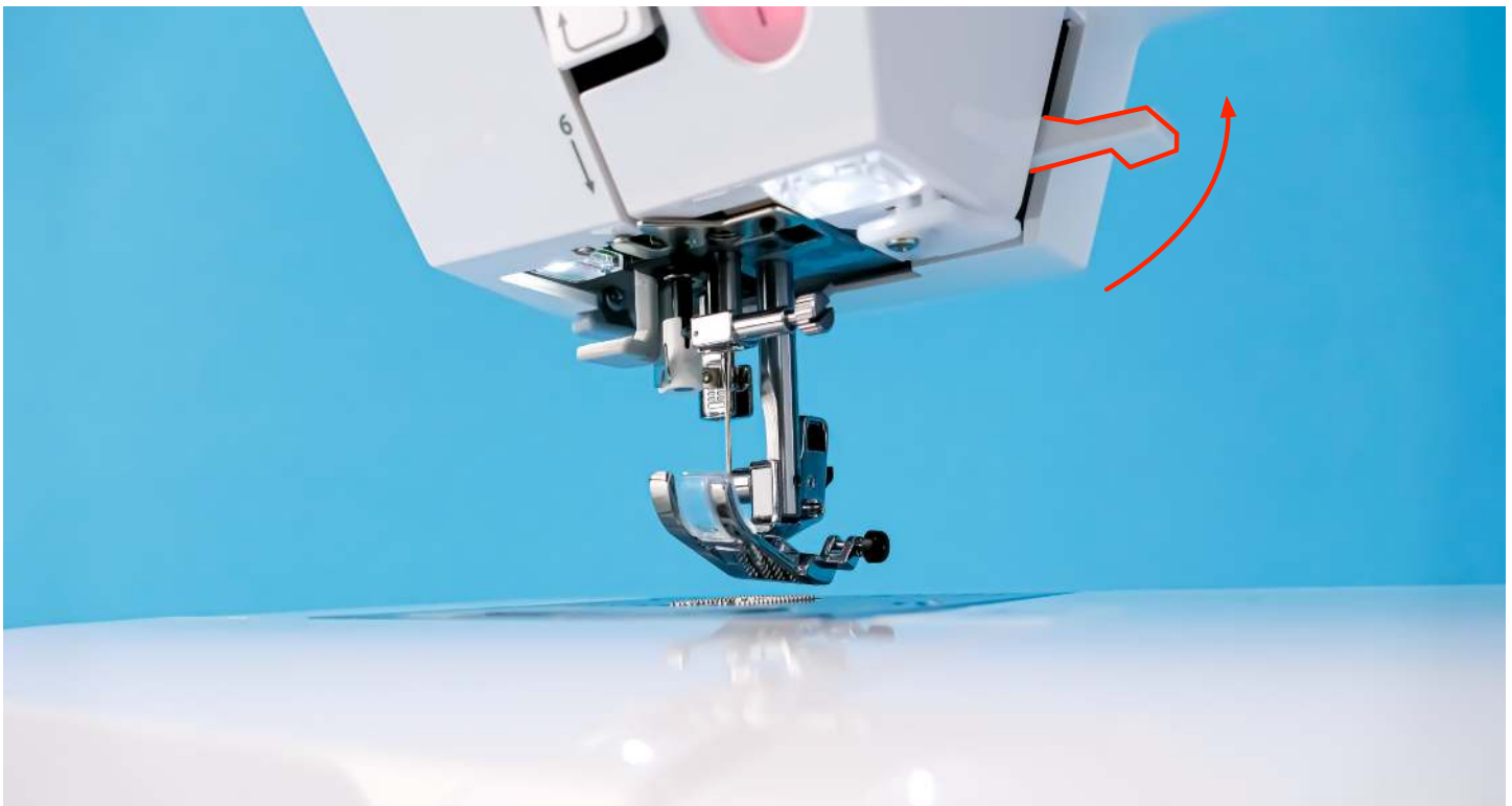
3. Stellen Sie den Nähfuß - Hebel nach oben. Der Nähfuß rastet in der oberen Position ein.
