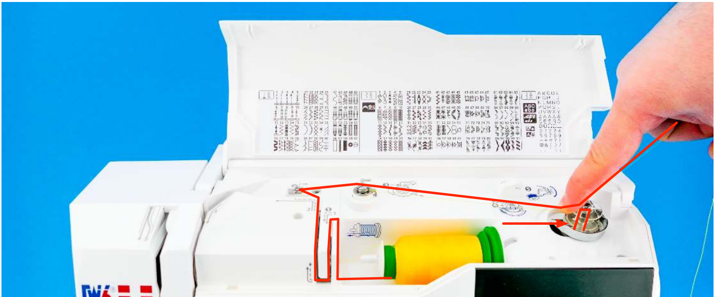
14. Drücken Sie die Spulerwelle mit der W6 Kunststoffspule gefühlvoll nach rechts gegen den Stopper der Spulerwelle. Halten Sie den Faden mit der anderen Hand fest.
