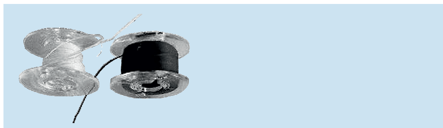
Spulenwicklung: links - falsch | rechts - richtig
